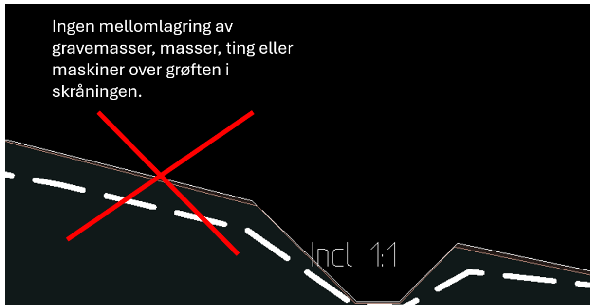
Figur 18: Det skal ikke påføres last i terrenget over grøfteskråningen.
