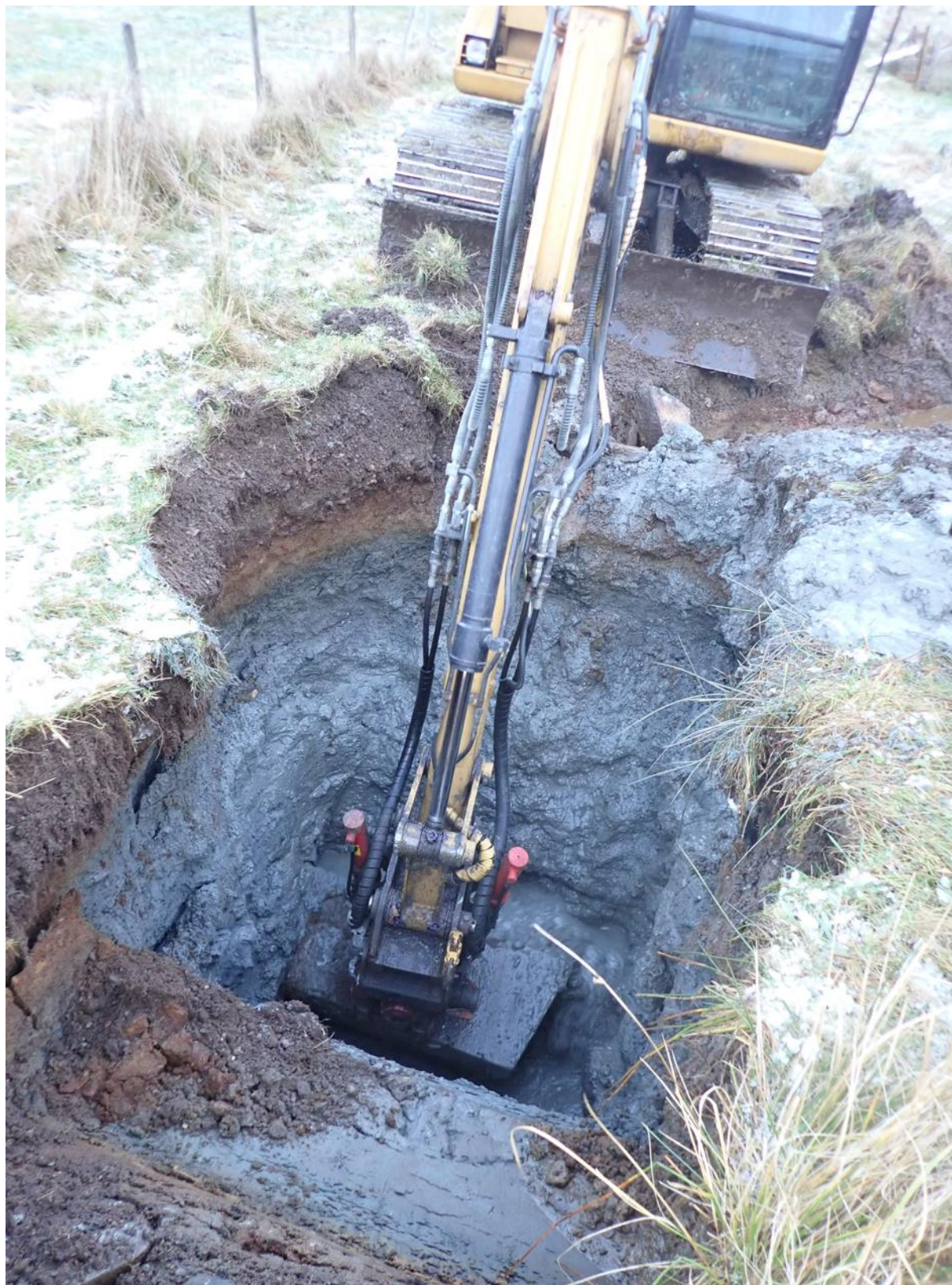
Figur 12: PGR7, leire og silt med steiner under topplag av grusige masser og matjord.
